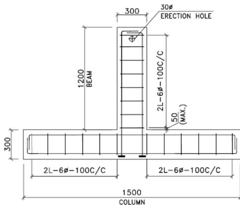
Fig. 1a. Specimen Type-A(ACI-352)
